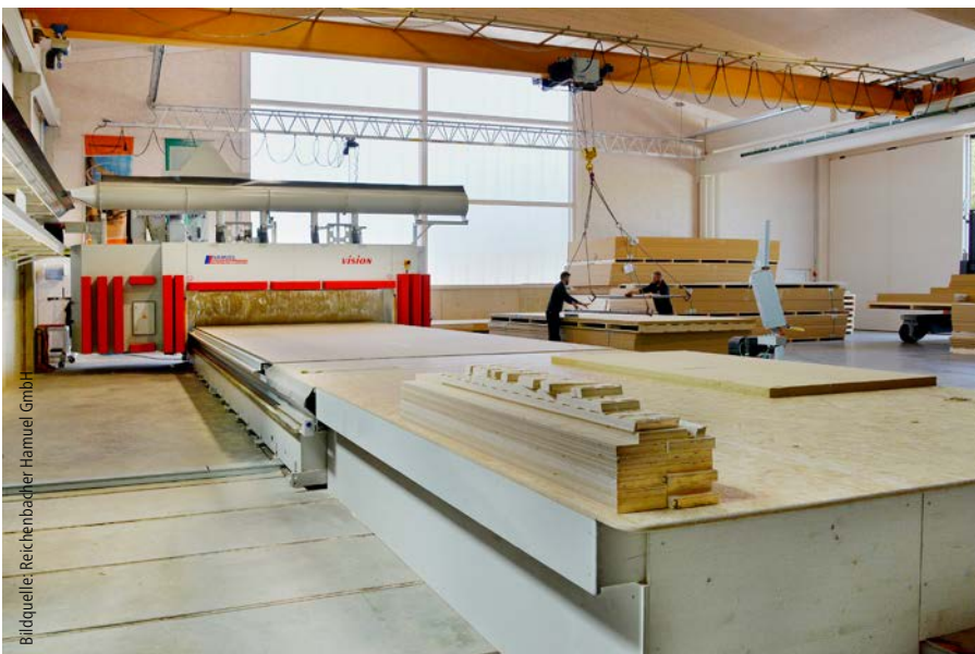
Die neue Vision-III-TTT-H 5-Achse hat eine gerastete HPL-Tischplatte und sticht mit ihren 9.000 mm Länge, 3.600 mm Breite und einem Z-Hub von 780 mm im Hallenneubau im württembergischen Satteldorf sofort ins Auge.
