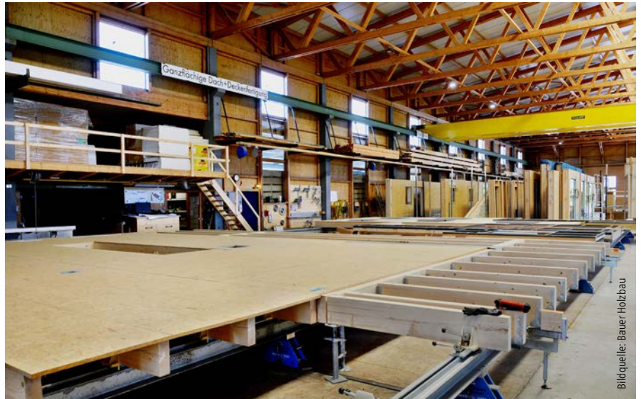
Mit dem von Walter Bauer selbst entwickelten Montagetisch Tectofix können auch komplexe oder verschachtelte Wand-, Decken- und Dachelemente bearbeitet werden, indem Balkenlagen oder Sparren auf beweglichen Längsträgern in flexiblen Spannschuhen fixiert werden.
