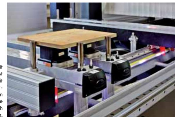
Am Maschinenbett und auf den einzelnen Trägern sind LED-Positionierstreifen angebracht, die die Position der Träger und der Sauger anzeigen.
