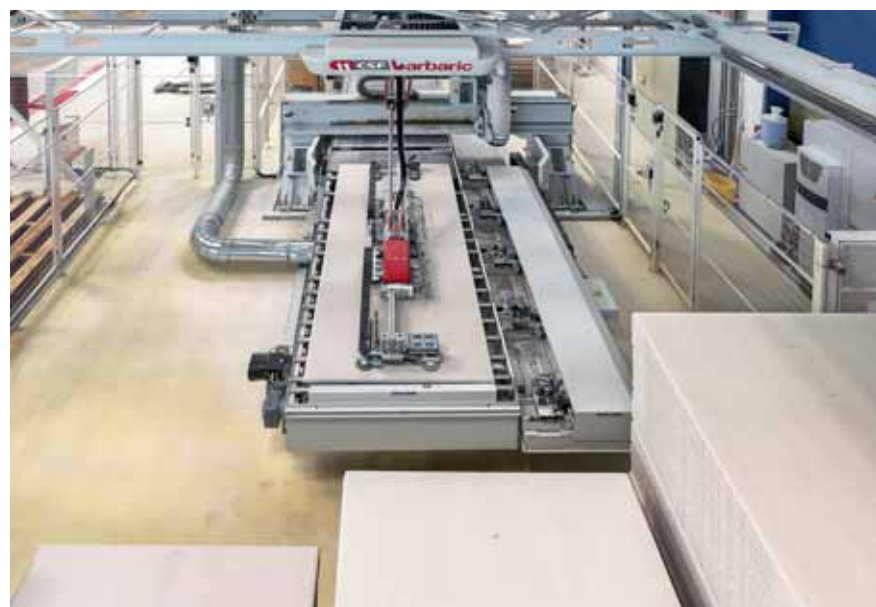
Vorgelagert an die Maschine ist ein Flächenlager mit 14 Plätzen. Die Anordnung der Plattenstapel orientiert sich an den Verbrauchsmengen
