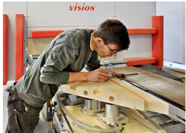
► Maschinenbediener Tobias Krebsler bei der Kontrolle zur Maßgenauigkeit bei einer fertig gefrästen Innenwange mit Handlauf.
