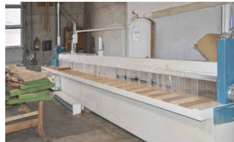
7 Am Anfang der Prozesskette steht eine moderne Besäumsäge – zumindest beim Schreiner Raßhofer, dessen Massivholzanteil bei etwa 90 Prozent liegt
