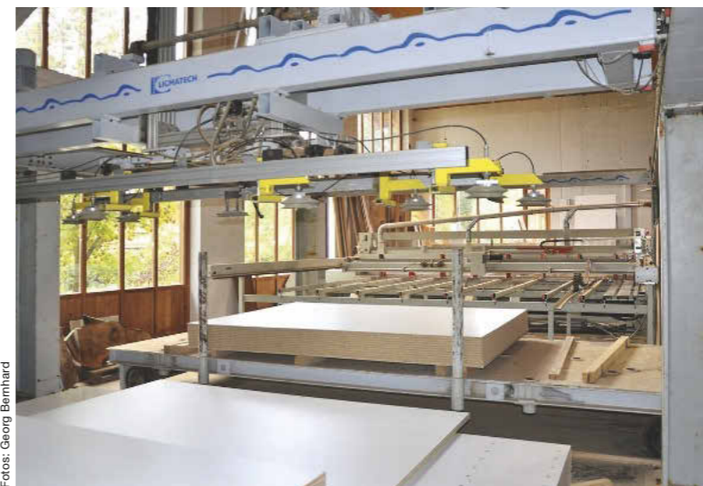
8 Technisch auf der Höhe: ein kleines automatisches Plattenlager, dessen Saugtraverse eine Plattensäge versorgt
