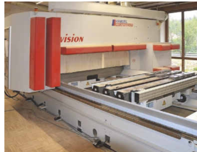
2 Das BAZ verfügt über zehn Konsolen mit jeweils vier Aufnahmen für Sauger oder Klemmspanner. Alles positioniert sich automatisch
