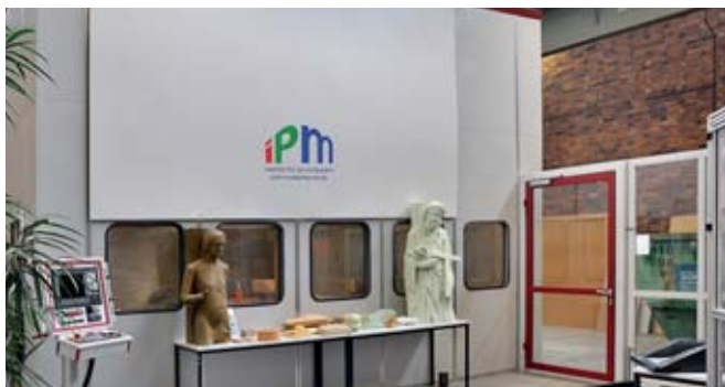
Die Reichenbacher Anlage ist aufgrund der beachtlichen Tischgröße und Tischausführung als schwere Schweißkonstruktion ausgeführt und komplett von einer Schutzkabine umschlossen.
