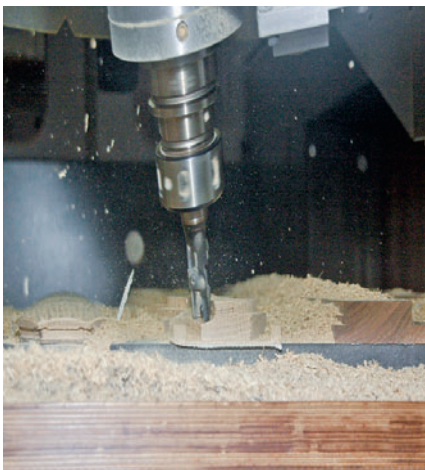
Fräsen der einzelnen Fußballsegmente im rationellen Nestingverfahren
