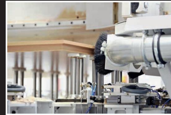
◀ Parallelbearbeitung der Schlosskastenseite mit Zusatzaggregaten
