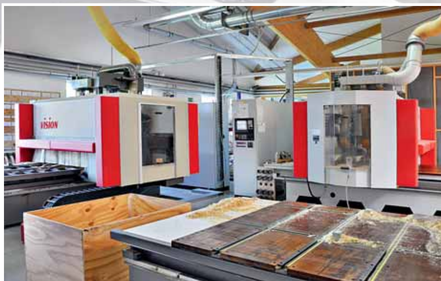
Links: Die Anlagen vom Typ „Vision Inline“ werden üblicherweise mit drei Blöcken nebeneinander bestückt, die alle separat ansteuerbar sind. Rechts: Insgesamt sind sechs Maschinen von Reichenbacher im Einsatz
