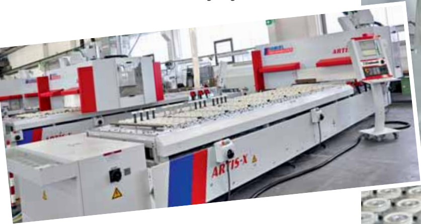
Auf dem feststehenden Maschinentisch der „Artis X6 Sprint“ sind insgesamt 494 Pins installiert
