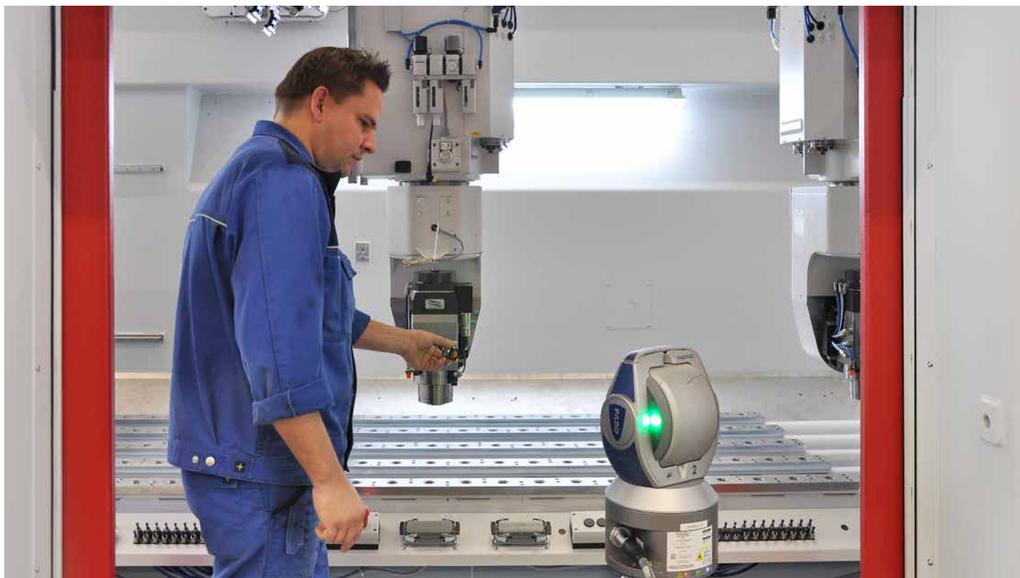
Der FARO Laser Tracker bei der Verifizierung der Positionsgenauigkeit einer Bearbeitungsmaschine der Reichenbacher Hamuel GmbH.
