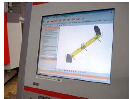
Mit „NC-Hops“ wird programmiert, das „FKM“ definiert die zu fertigenden Einzelteile und das „Workcenter“ ermittelt automatisch die notwendigen Spannerpositionen und liefert zusammen mit dem „Fünf-Achs-Post“ alle erforderlichen CNC-Programme.
