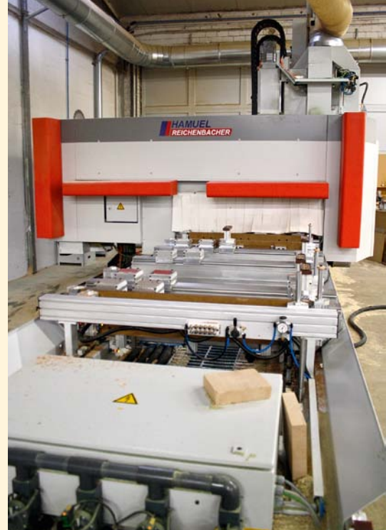
Bei der Wilhelm GmbH in Wees kommt als CNC-Bearbeitungszentrum eine Reichenbacher „Vision 6000“ mit fünf Achsen und Siemens „840D“-Steuerung zum Einsatz.
