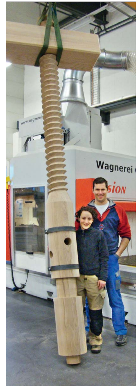
Fertige Spindel der antiken Traubenpresse mit 4,1 m Höhe und 250 kg Gewicht
