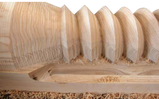
Aufgespanntes Rohmaterial der Traubenpresse mit einseitig gefräster Kontur einer Spindel (Fotos: Oehrli, Reichenbacher Hamuel)
