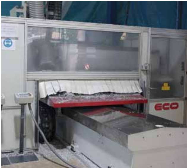
Bild 4: Das textile Schutzsystem ist ebenfalls an dem Bearbeitungszentrum ECO von Reichenbacher Standard.
