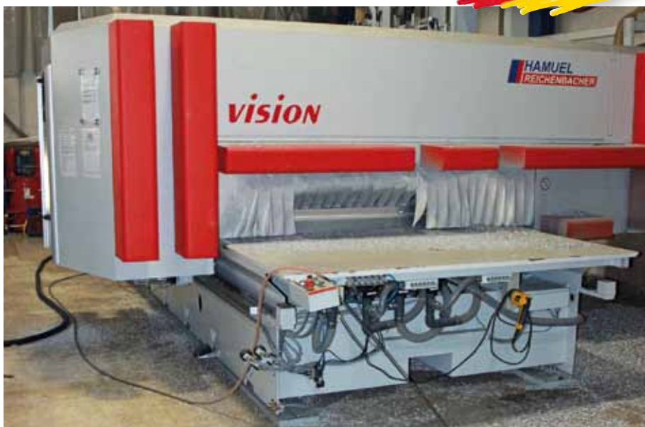
Bild 3: Das CNC-Bearbeitungszentrum Vision von Reichenbacher Hamuel ist mit dem Schutzvorhang ausgestattet und kommt bei JVK Filtration Systems zur Herstellung von Kammerfilterplatten zum Einsatz.
