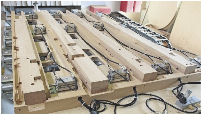
/ Pfiffige Eigenentwicklung von Wortmann: In dieser durchdachten Vorrichtung können vier Pfosten gleichzeitig gespannt und dann bearbeitet werden.
