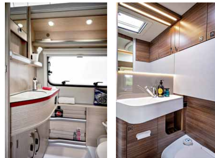
Badausstattung in einem Hymer-Caravan mit hochklappbarem Waschbecken (oben)
