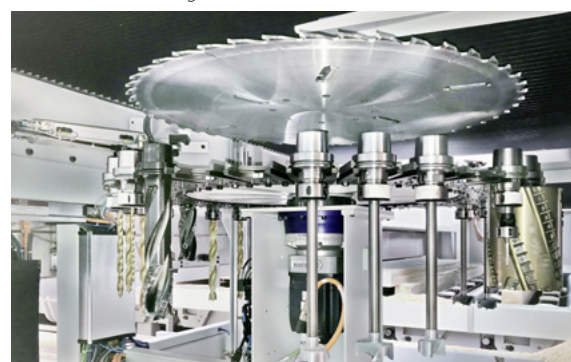
Bei Derix in Westerkappeln installierte Reichenbacher Hamuel ausgesprochen kompakte und leistungsstarke Fünf-Achs-CNC-Zentren
