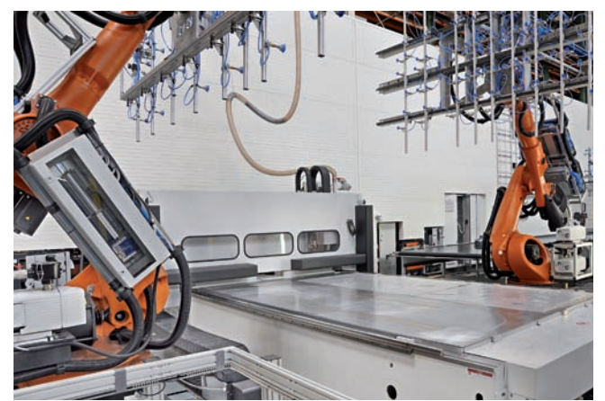
Der groß dimensionierte Bearbeitungstisch erlaubt Mehrfachbelegung
