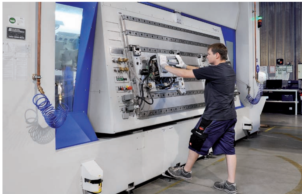
Maschinenbediener Maik Pfeiffer bei der Beschickung, die Spannfunktion erfolgt durch das Fußpedal
