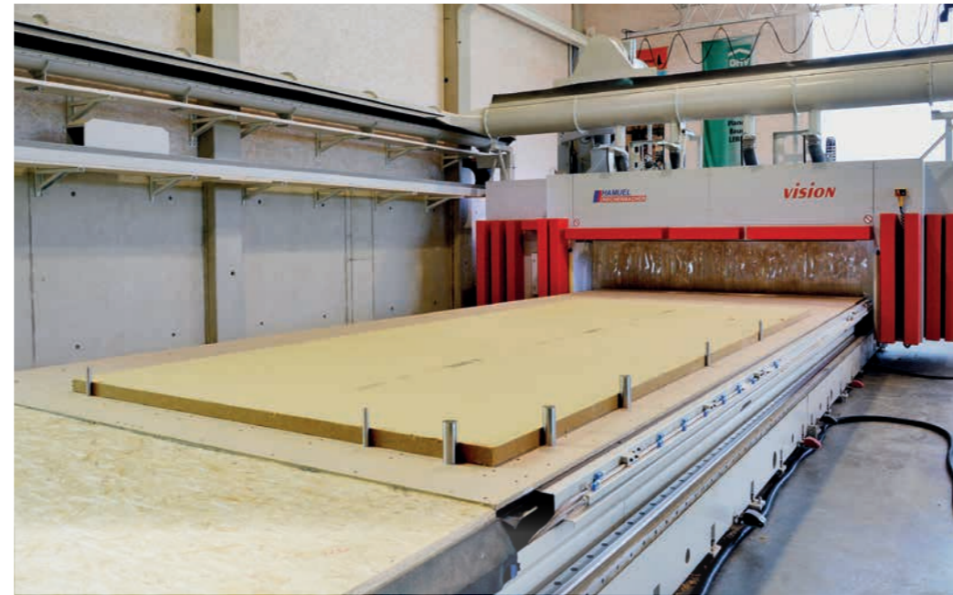
Bearbeitungstisch mit spezieller Tischverlängerung und Anschlägen.
