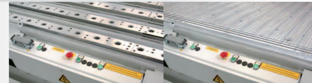
Der offene Rohrrahmentisch hat eine Flächenbelastung von bis zu 1.000 kg. Die Auflageleisten sind im Raster von 200 mm in Y-Richtung angeordnet und mit Gewinde und Passbuchsen im Raster von je 100 mm in X-Richtung ausgestattet. Das Spannen der Vorrichtungen erfolgt mechanisch über die Gewindebuchsen im Maschinentisch.
