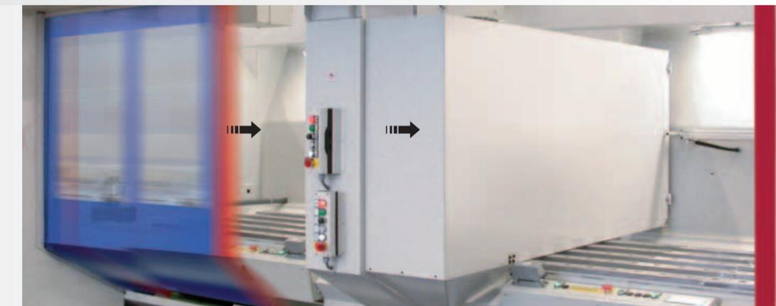
Der Beschickungsraum wird durch zwei Schiebeteile motorisch (Option) verschlossen. Bei wechselseitiger Beschickung kann jedes Tor einzeln geöffnet werden. Bei geöffneter Tür ist zur Absicherung gegen wegfliegende Teile aus dem gegenüberliegenden Arbeitsbereich ein Mittelschott vorgesehen. Neben den Tischen fallen die Späne ins Maschinenbett. Die Blechverkleidungen sind so ausgeführt, dass sich keine Spänenester bilden können.
